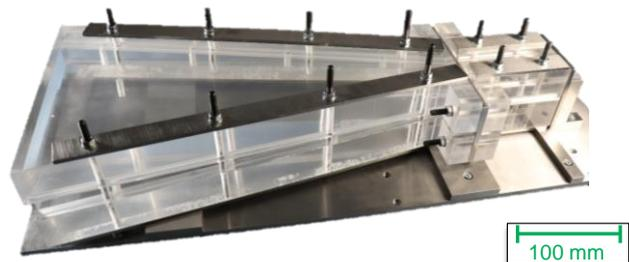
Abbildung 2: Aufbau der modularen, transparenten Injektionsbox zu Versuchszwecken
